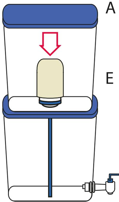
Placez le préfiltre (E) sur l'élément de filtre et placez le couvercle supérieur (A).
