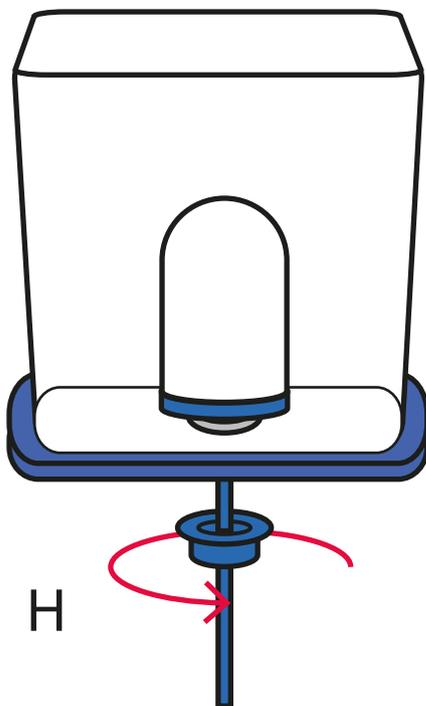
Fixez solidement l'élément de filtre Tulip (F) en utilisant l'écrou de filtre (H).
