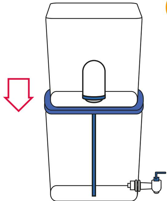
Placez le seau supérieur, avec le couvercle du seau inférieur, l'élément de filtre Tulip et le tuyau à débit rapide sur le seau inférieur.
