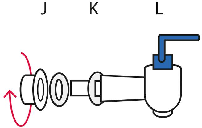
Dévissez l'écrou du robinet. Laissez un joint en caoutchouc (K) sur le robinet (L).
