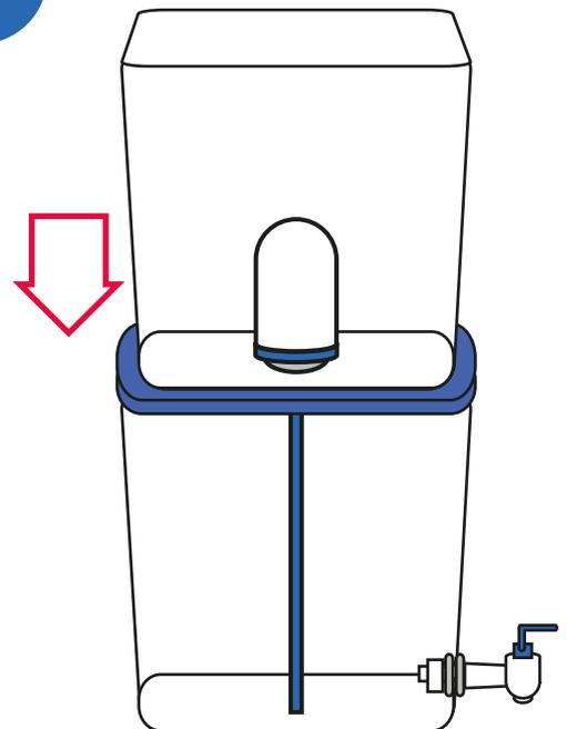
Placez le seau supérieur, avec le couvercle du seau inférieur, l'élément de filtre Tulip et le tuyau à débit rapide sur le seau inférieur.
