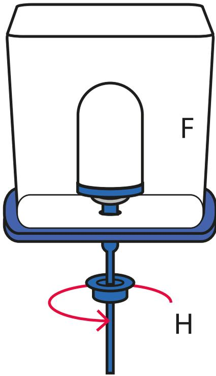
Fixez l'élément de filtre Tulip(F) en utilisant de l'écrou de filtre (H).
