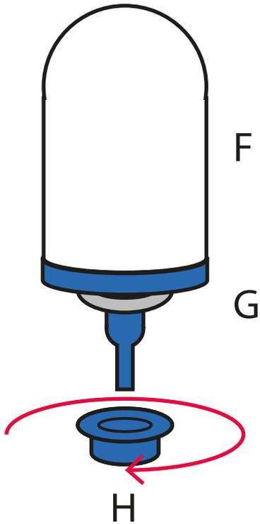
Retirez l'écrou du filtre (H) de l'élément de filtre Tulip (F).
