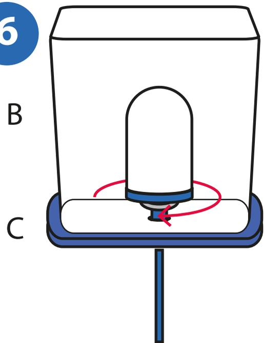
Vissez l'élément de filtre Tulip (F) avec le joint en caoutchouc (G) et le tuyau à débit rapide (I) dans le seau supérieur (B) et le couvercle inférieur (C). Assurez-vous que le joint en caoutchouc se trouve entre l'élément de filtre (F) et le fond du seau.
