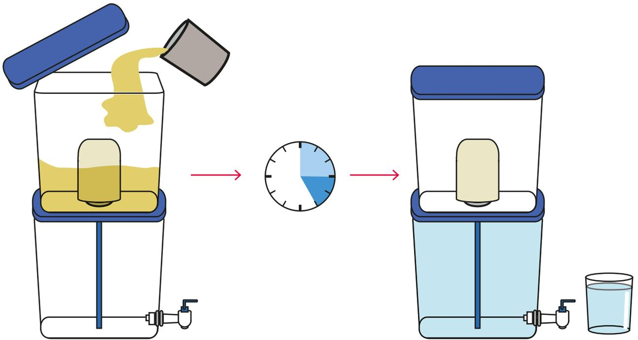
Eche agua sucia en el recipiente superior. El filtro dilatará 3-5 horas para limpiar un balde completo de agua sucia. Agua segura estará almacenada en el recipiente inferior. Agua segura se puede tomar del grifo.
