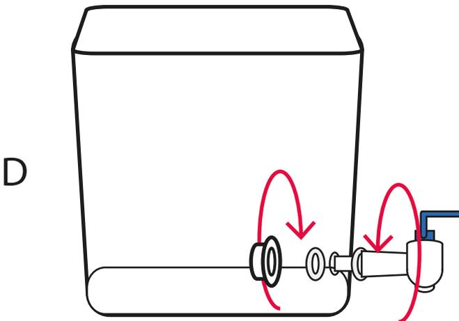
Apriete el grifo con el anillo de hule por el hueco del lado del balde inferior (D). Sujete el grifo estrechamente utilizando la tuerca del grifo (J).
