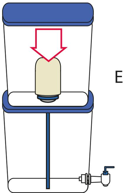
Para proteger el elemento filtrante contra la obstrucción, el elemento filtrante está cubierto con un pre-filtro lavable (E).
