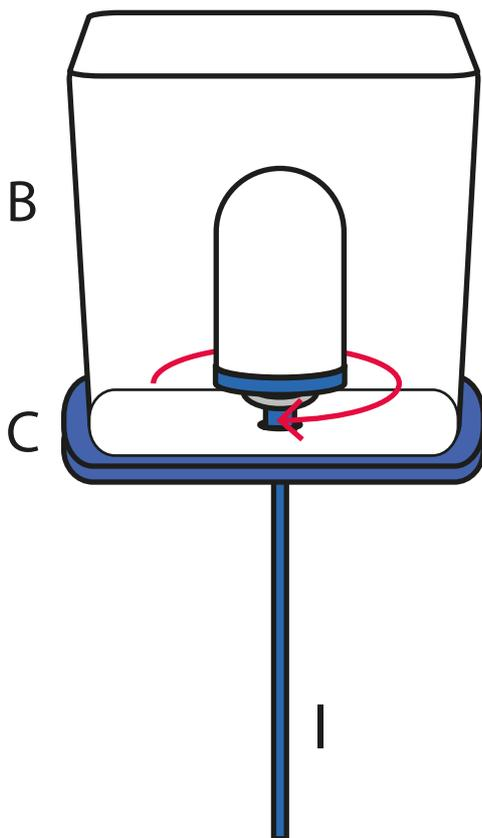
No empuje el elemento de filtro, sino voltéelo para evitar roturas y asegúrese de sujetarlo estrechamente.
