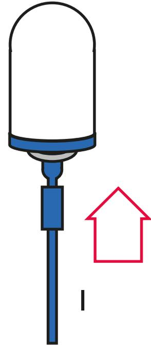
Adjunte el tubo de flujo rápido (I) al la punta del elemento de filtro Tulip (F) y asegúrese que esté sujetado estrechamente.
