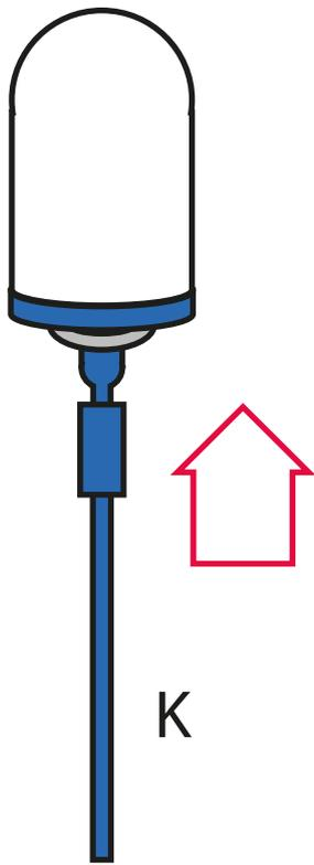
Adjunte el tubo de flujo rápido (I) al la punta del elemento de filtro Tulip (F) y asegúrese que esté sujetado estrechamente.
