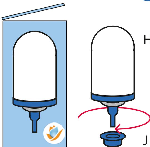
Saque un Nuevo elemento filtrante de la caja. Quite la tuerca del filtro (H) del elemento del filtro Tulip (F).
