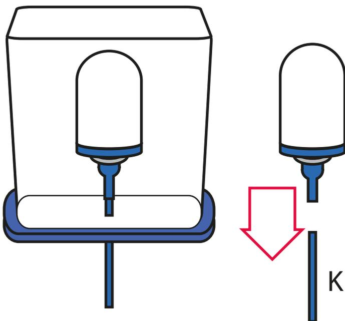
Saque el elemento de candela de cerámica. Separe el tubo de flujo rápido (I) del elemento filtrante.
