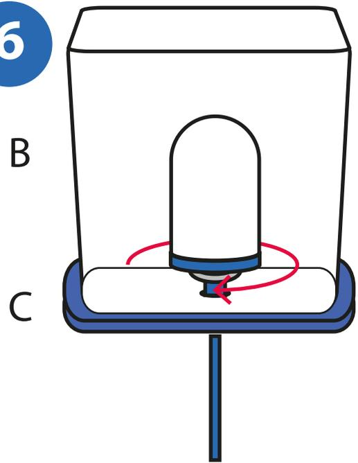
Apriete el elemento de filtro Tulip (F) con el anillo de hule (G) y el tubo de flujo rápido (I) dentro del balde superior (B) y la tapa inferior (C). Asegúrese que el anillo de hule (G) esté entre el elemento de filtro (F) y la parte inferior del balde.
