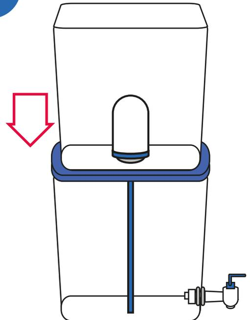
Ponga el balde superior, con la tapa del balde inferior, el elemento de filtro Tulip y el tubo de flujo rápido sobre el balde inferior.
