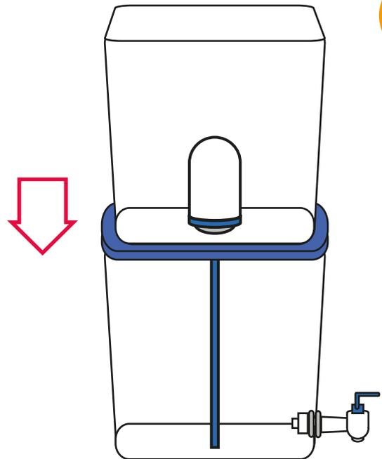
Ponga el balde superior, con la tapa del balde inferior, el elemento de filtro Tulip y el tubo de flujo rápido sobre el balde inferior.
