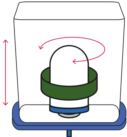
Después de algún tiempo, la velocidad de flujo reducirá. Tome la pieza para limpiar el filtro (M) y cepille cuidadosamente el elemento filtrante para eliminar una pequeña capa de material cerámico.
