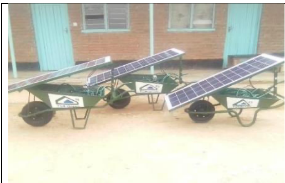
Una bomba, panel, manguera y cable montados en una carretilla. Se transporta fácilmente a campos de distancia para riego
