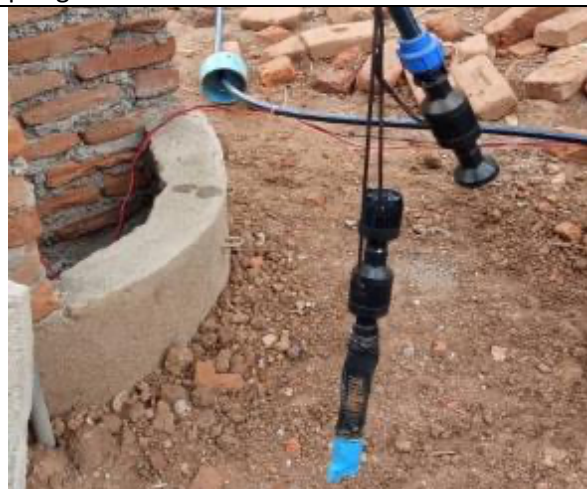
A veces, la tapa superior de la bomba modelo 38 puede aflojarse, especialmente si se montan más bombas en serie.
